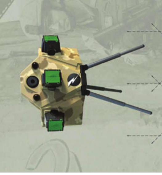
Tasernet, Remote Area Denial System: Ein auf der Taser-Technologie beruhendes, alleinstehendes Verteilungssystem für Gebäude und Gelände mit drei integrierten Elektroschockern. Bild: Taser International
